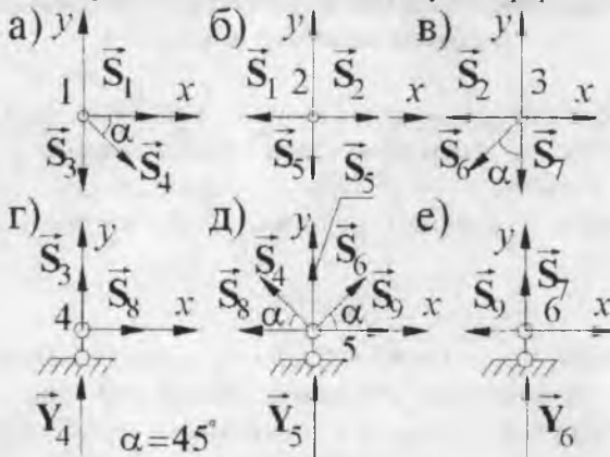
Рис. 3. К составлению уравнений равновесия заданной системы методом вырезания узлов
