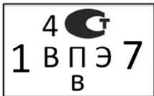
Рис. 3. Знак поверки, применяемый метрологической службой юридического лица при клеймении средств измерений, выпускаемых из производства
