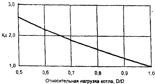
Рис. 2. Зависимость K_d от относительной нагрузки котла.
