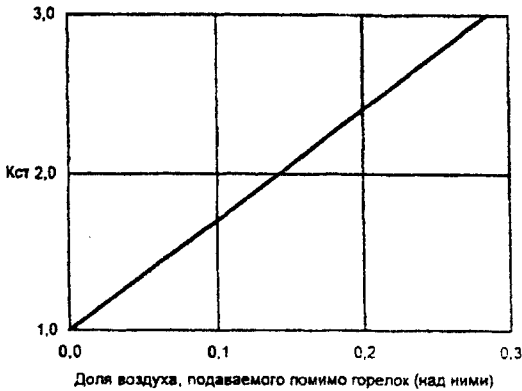
Рис. 4. Зависимость K_{ctm} от доли воздуха, подаваемого помимо горелок.
